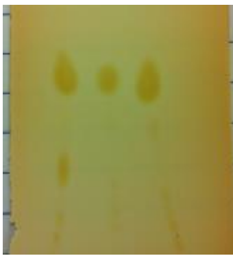
1 – Hazelnut standard, Rf TAG 0.497 2 – Hxn:Iso 10:1 at 100°C, Rf TAG 0.464 3 – Hxn:Iso 2:1 at 130°C, Rf TAG 0.481
